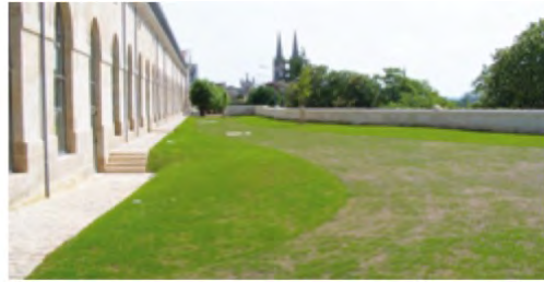
Voie d'accès pompier pas dalles alvéolées remplies de gazon (Plantes et Cité)
