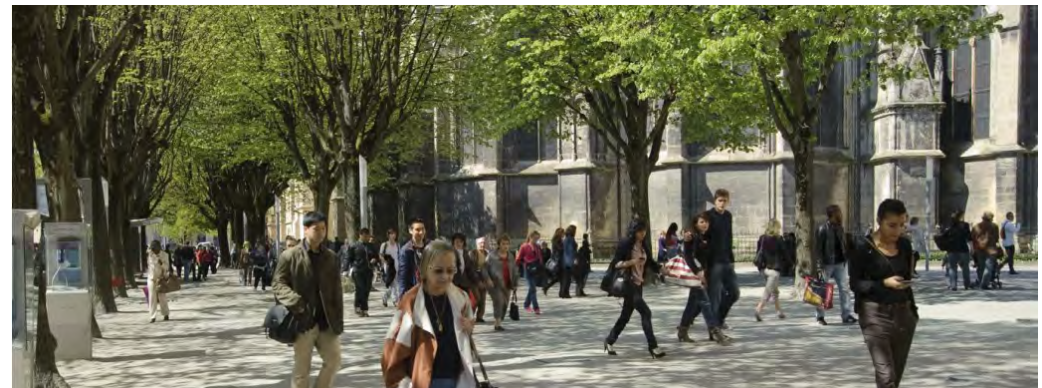
Plateforme multimodale - place Pey Berland - Bordeaux (AURBA 2020) Le sol au pied des alignements de platanes de la Place Pey Berland est un stabilisé qui infiltre l'eau de pluie et participe à l'îlot de fraîcheur. Bien connu par les usagers pour ne pas être le plus abouti des aménagements (flaques et poussière), cette manière d'aménager reste très adaptée du point de vue de la lutte contre les ICU.
