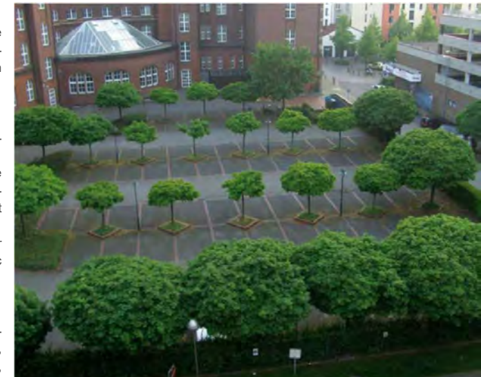
Dans ce parking situé à Gelsenkirchen en Allemagne, les différents taux de croissance des arbres (tous de la même essence et plantés en même temps) ne s'expliquent que par les variations dans le volume de substrat non compacté qu'ils peuvent exploiter. (Trees and Design Action Group, Image : Johan Östberg)
