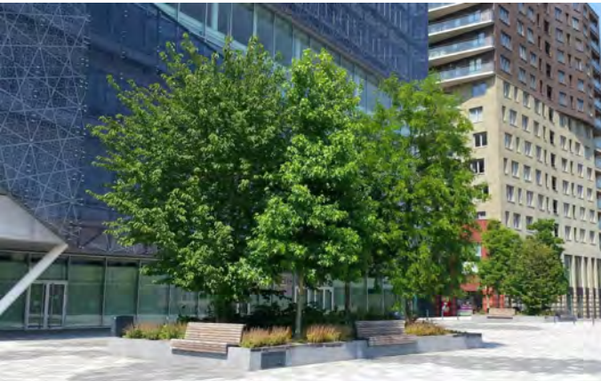
La jardinière peut être entourée de mobilier urbain. Si le substrat est mis en contact avec le sous-sol (enlèvement du revêtement), la profondeur totale peut atteindre 1.5 m et permettre de planter des arbres de taille moyenne.
